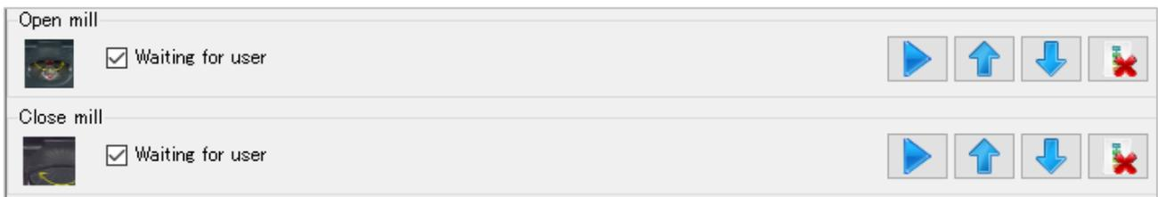
装置を「Open mill」と「Close mill」コマンドは同じように見えます。これらには、アイコン、コマンド名、およびアクティブなユーザー入力(Waiting for user)を介して開閉できるスイッチのみが含まれています。ユーザー入力(Waiting for user)にチェックを入れた場合、プログラムは、オペレーターが OK を与えるまでコマンドの実行を待機します。**※PL-5 では非推奨**
