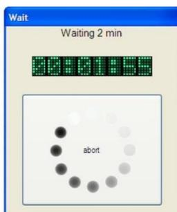
このダイアログウィンドウ（左側の図を参照）は、「Waiting」コマンドに対して表示されます。設定された待機時間は、経過時間とともにタイマーが実行されている上部と下部に表示されます。下部には大きな「abort」ボタンがあり、クリックすると一時停止が終了し、SOP 全体の実行が終了します。
