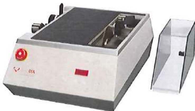
図 2 .スプラッシュガードを外した状態の切断機
