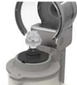
3 ▶ ディスポーザブル容器をアダプターに取り付けます。カップリング（シャフト部分）に容器を押し付けて、時計回りに回転させて固定します。
