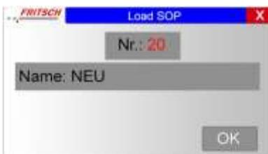
「Load SOP」の画面が開きます。ダイヤルを回して「OK」を押すと、選択された SOP が読み込みます。
