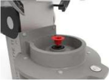
本装置は、ナイフカップリング(品番:11.3205.16)を使用して、ナイフホルダーの磨耗を最小限に抑えています。このナイフカップリングは、装置の部品によって、また回転刃を交換するたびにチェックする必要があります。目視で確認できる磨耗の場合には、付属スペアパーツと交換して下さい。
