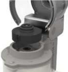
1 ▶ ディスポーザブル容器用アダプターを装置に取り付けます。
