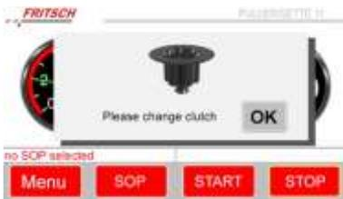
装置の損傷を防ぐ為に、少なくとも 200 時間の運転後にナイフカップリングを交換して下さい。200 時間の運転後、装置画面にナイフカップリングを交換するように促すメッセージが表示されます。
