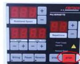
2. その状態で本体背面にある電源スイッチ(8)を ON にします。その後、STOP ボタンから手を離します。
