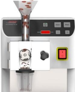
試料はファンネルを介して、粉碎室へ供給されます。そこでは、固定ナイフ(8)と組合された回転ナイフ(13)が試料を切断します。細かく切断された試料は、ふるいインサート(7)を通過して、回収容器(6)に落下します。
