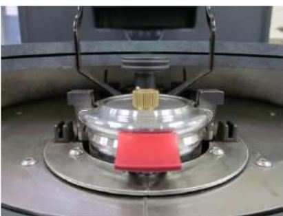
容器を容器ホルダーに軽くのせます。この時チャックの位置をホルダーの溝にあわせて下さい
