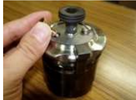
蓋上面の残りの穴へリリースバルブを取り付ける
