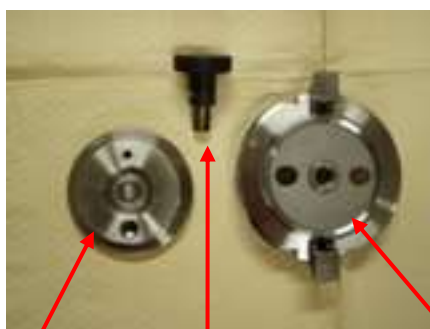
①内蓋 ②締め付けボルトノブ ③外蓋
