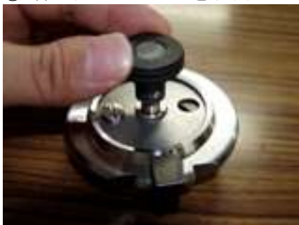
締め付けボルトネジを蓋上部真ん中の 穴に入れる。 ※ このときボルトは少しねじ込む程度にする。
