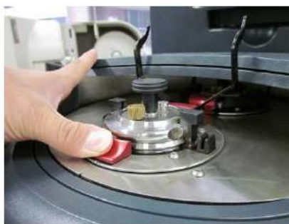
脱着ボタンを押します。すると、容器が沈みます
